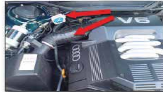
Einbaubeispiel in einem Audi A6. Air-Tec Gerät und Spule auf dem Ansaugschlauch.
