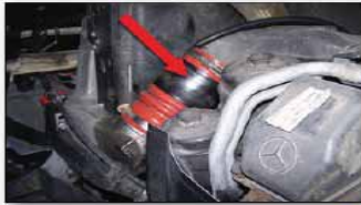
Vorgefertigter Lackluftschlauch, der mit einem Spulensystem konfektioniert wurde, ersetzt MB Teilenummer A 003 094 98 82.
